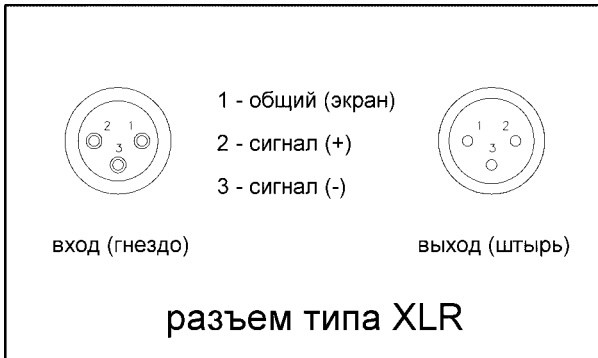
Рис.3. Функциональное назначение выводов разъемов
